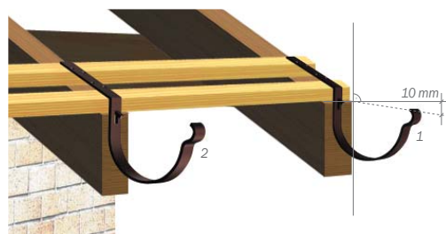
Obr. 7 – umístění háků do krokví, ohyb od objektu
